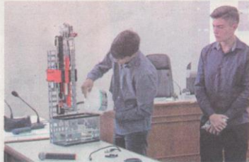
GRUPO demonstrou o funcionamento do protótipo: sensor lê e avisa sobre nível da água enquanto a esteira garante que o robô não fique submerso
